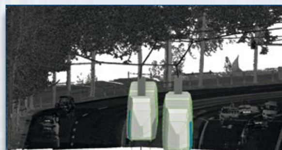
Bild 5: Punktwolkenauswertung mit Fahrdrakt und Position des Stromabnehmers zweier NGTW6-Leoliner im Begegnungsverkehr, Quelle: Leipziger Verkehrsbetriebe (LVB).
