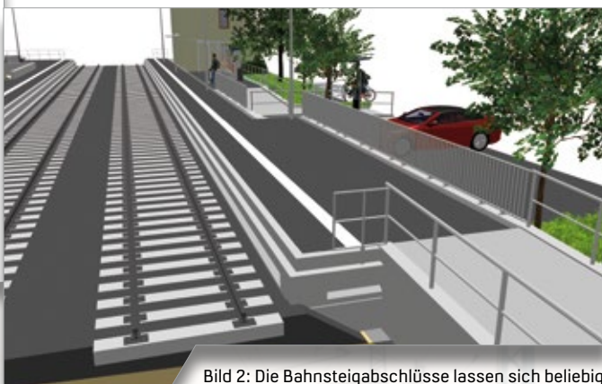
Bild 2: Die Bahnsteigabschlüsse lassen sich beliebig gestalten, um so zum Beispiel eine Rampe zu ergänzen.
