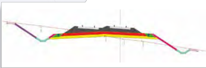
Bild 1: Zweigleisiger Bahnkörper mit Voreinstellungen.
