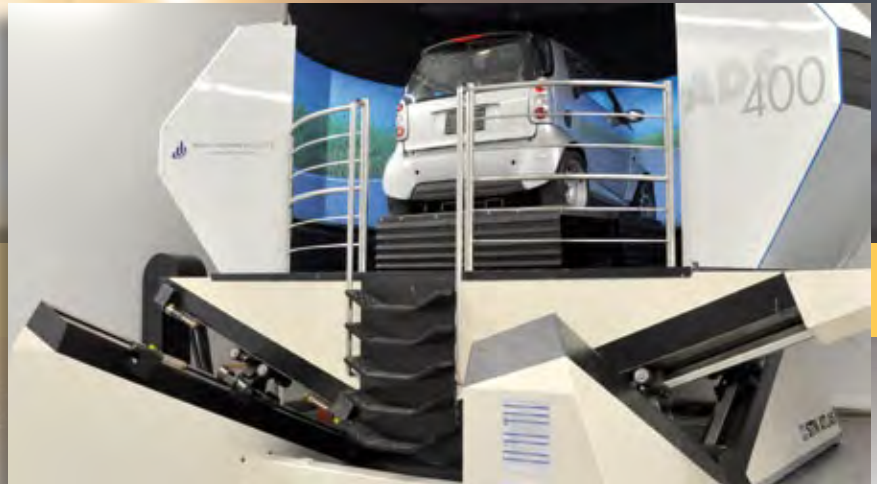
Außenansicht des interaktiven Fahrsimulators TRAFFIS mit Bewegungsplattform zur realistischen Nachbildung der Lenk- und Hubbewegungen des Fahrzeugs.
