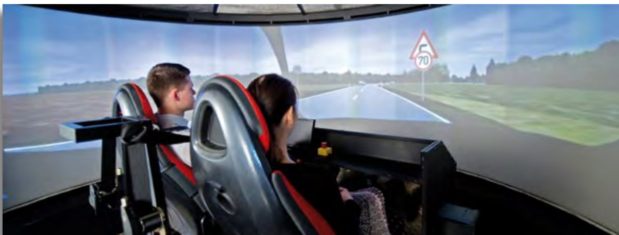
In der Fahrzeugkabine des TRAFFIS-Fahrsimulators stellt das Visualisierungssystem die virtuelle Umgebung auf einer Rundprojektion dar, die das gesamte Blickfeld der Insassen abbildet.
