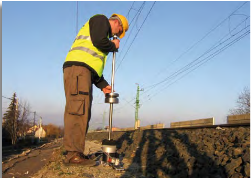
Der Deflektometer (leichtes Fallgewichtsgerät) dient zum Aufspüren unzureichender Tragflächen bei Zustandserfassungen.
