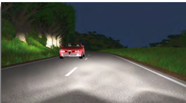
Ausleuchtung des Straßenraums vor dem Fahrzeug durch Scheinwerfer mit adaptiver Anpassung des Lichtkegels und der Ausrichtung des Scheinwerfers in Echt- und Falschfarbdarstellung.
